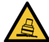
Warnung vor Kippgefahr beim Walzen
